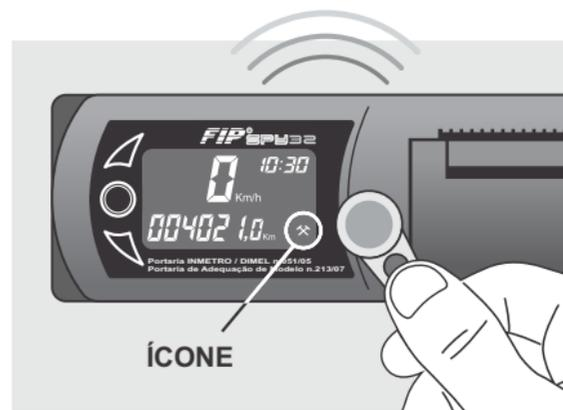
Com o tacógrafo ligado, o condutor deve encostar por alguns segundos a parte metálica do chaveiro nos contatos do identificador, até que sejam emitidos três sinais sonoros ('bips'); neste instante o ícone de trabalho é visualizado no display.
